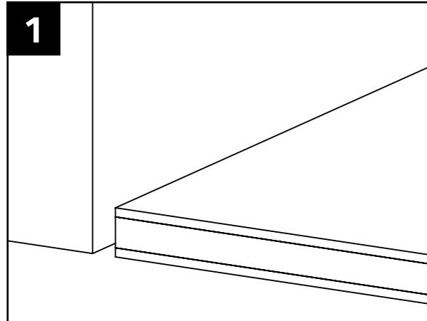
Die Breite der Anschlussfuge sollte je nach verwendetem Abschlussystem zwischen 4 und 12 mm sein (siehe Datenblätter). Ebenfalls zu berücksichtigen ist die Stärke des Bodenbelags. Unsere Systeme des Typs X5 können bereits ab einer minimalen Bodenbelagsstärke von 5 mm eingesetzt werden.
