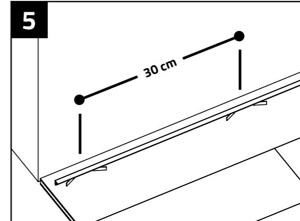
Montageclips alle 30 bis 60 cm in die Abschlussleiste einsetzen.
