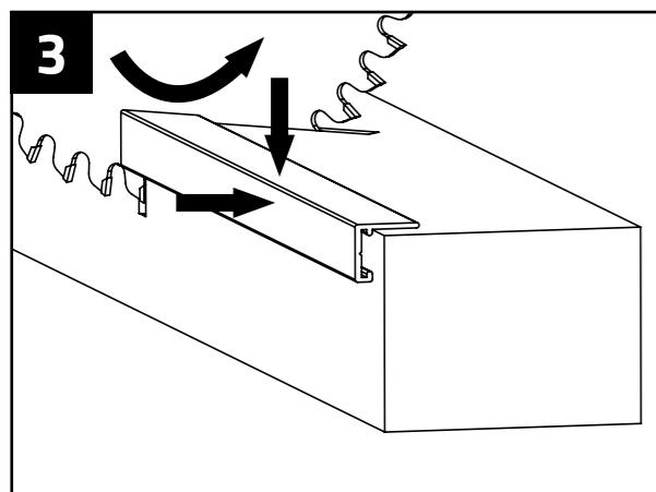
Die Profile werden passend abgelängt. Hierbei wird in einem Arbeitsgang der Gehungsschnitt für Innen- oder Außencke angebracht. Das Profil wird dabei sicher auf einen Holzträger gedrückt und in der Säge schnittgerecht positioniert. Die Schnittrichtung der Säge drückt dabei das Profil beim Schneidevorgang an den Holzträger.
