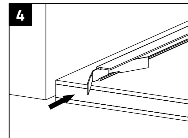
Die Montageclips werden stirnseitig in die Abschlussleiste eingeschoben. Achtung: In der Abschlussleiste sind zwei gegenüberliegende Vorsprünge eingearbeitet, zwischen denen die Montageclips leichtgängig geführt werden.
