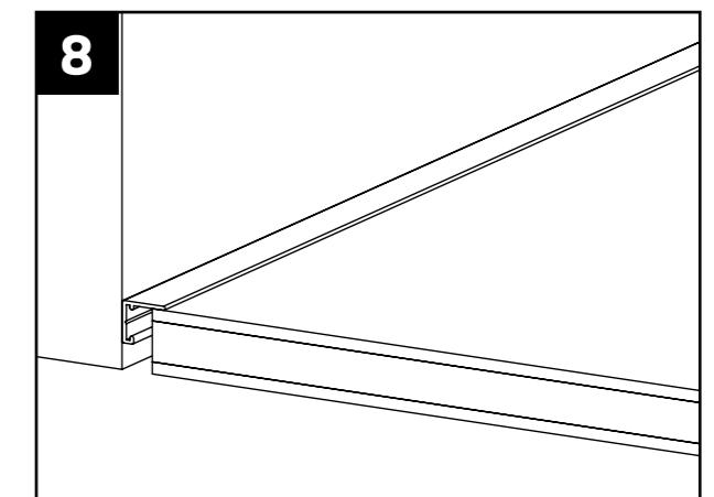
Die Abschlussleiste ist montiert. Nach einer kurzen Kontrolle kann das nächste Teilstück montiert werden.
