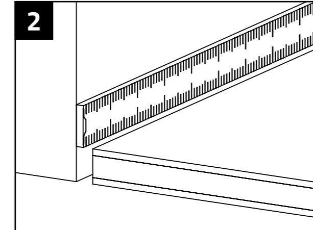
Die Abmessungen für die Profilzuschnitte werden an den Wandflächen abgenommen. Gehungsschnitte für Innen- und Außencken werden hierbei berücksichtigt.
