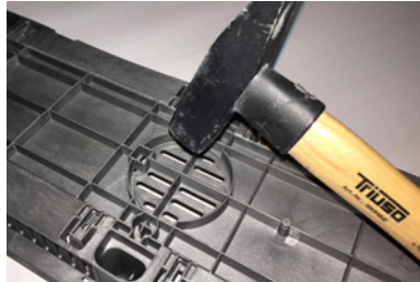
Ausschlagen der Bereichs für den Einsteckstutzen
