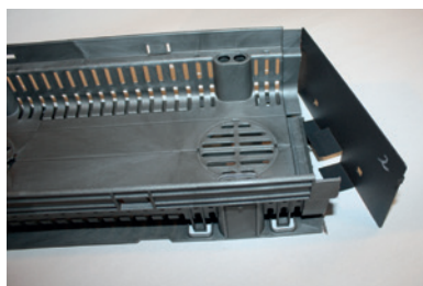
Ansetzen der Stirnwand
