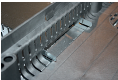
Einschieben des Stichkanals
